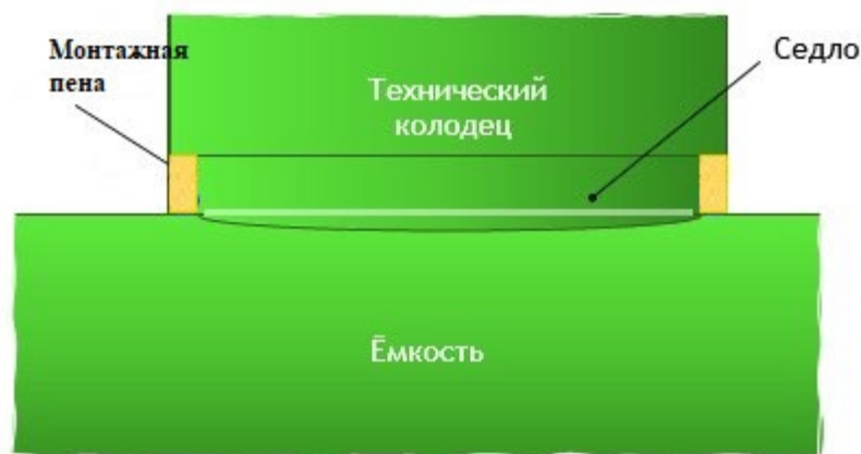
Рис. 17. Установка технического колодца
