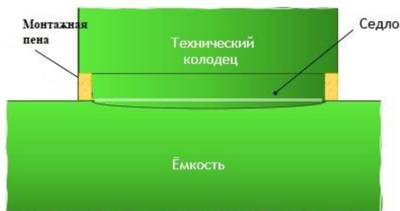
Рис. 19. Установка технического колодца
